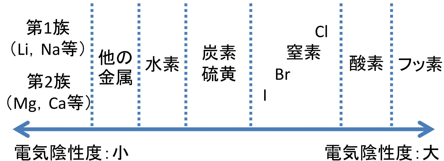
上の表で、電気陰性度の異なる元素が結合を作ると、電気陰性度の大きい元素が電子を全部持つて行く(と考える)。
