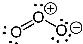
この図が正しければ、左の $O=O$ 結合は二重結合なので右の $O-O$ より強く短い。しかし実際には、左右の結合は等しい。
